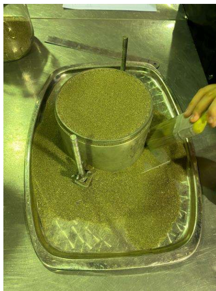
شکل ۵ - تمیز کردن ماسه‌های ریخته شده در اطراف نمونه به جهت نبود خطا
