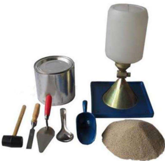
شکل ۳- وسایل انجام آزمایش دانسیته در محل
